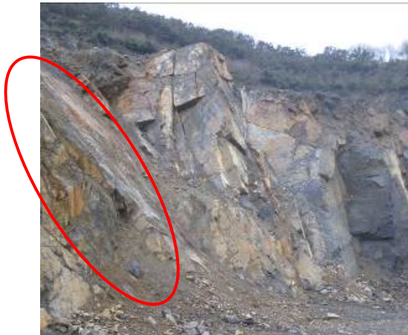
Figure 12 : Possible surface d'un glissement antérieur, en concordance avec le plan de fracturation P1.
